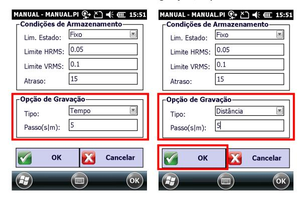
7 – AJUSTE DO PONTO DE INCLINAÇÃO: Nesta opção configuramos as precisões de armazenamento e de gravação para utilização da função "Inclinação" (Coleta de pontos com o bastão inclinado).
