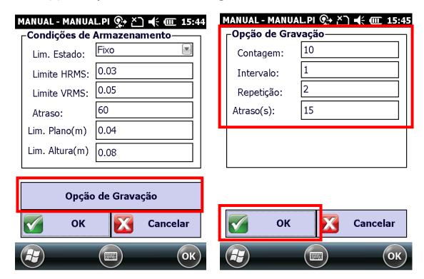
5 – CONFIGURAÇÃO DE PONTO RÁPIDO: Neste modo podemos configurar a precisão da coleta de pontos rápidos:
