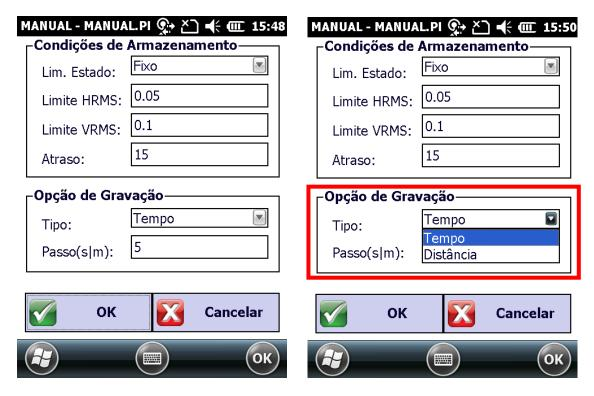
As imagens abaixo demonstram a configuração por "Tempo", com coleta de pontos a cada 5 segundos e por "Distância" com coleta de pontos a cada 5 metros. Para confirmar as configurações, clique em "OK":
